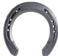
15% plus léger que le modèle standard, le fer Equi-Librium Air permet un départ du pied plus fluide, ce qui diminue le pic de charge tout en améliorant la coordination du cheval. La section concave au niveau de la pince améliore l'accroche. Sa couverture en éponge apporte un support optimal. Les pinçons latéraux sont positionnés en pince pour un meilleur maintien tout en assurant le bon fonctionnement du pied. La pince arrondie facilite le départ du pied.
