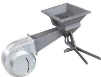
Foyer en fonte de dimensions intérieures 270x190x50 mm. Equipé d'un système de régulation du flux d'air grâce à une soupape centrale commandée par un levier. Un deuxième levier commande une trappe d'évacuation du mâchefer.
