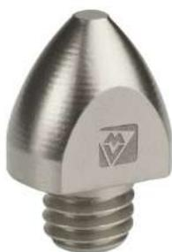
Fers d'épaisseur 8 ou 10 mm. Terrains gras/sable. Tête ovale diamètre 17 mm, clé de 12 mm, dépassement 17 mm au-dessus du fer. Percer Ø 8,5 mm et utiliser un taraud M10x150.
