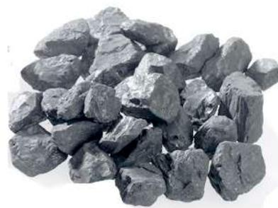
Charbon manufacturé calibré 10/25 mm. Très forte chaleur sans générer de flammes. Combustion provoquée par apport d'air. Très peu polluant, dégage peu de fumée. Plus de propreté. Plus de combustion. Plus de transfert de carbone vers l'acier.
