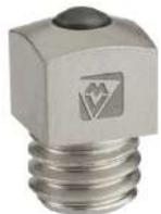
Fers d'épaisseur 8 ou 10 mm. Terrains durs et glace. Tête carrée, clé de 10 mm, dépassement 10 mm au-dessus du fer. Percer Ø 8,5 mm et utiliser un taraud M10x150.
