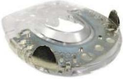
CARRÉstep Standard (EasyShoe Versa Grip) : ferrure composite bi-matière (métal et polyuréthane). 20 à 30 % plus léger qu'un fer standard, réduisant la charge sur les membres du cheval. Structure résistante à la torsion, grande durabilité. Profil épais avec semelle à relief profond pour une adhérence optimale. Design antidérapant minimisant
