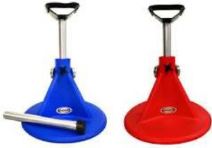
Trépied à base ronde en plastique Blacksmith à hauteur réglable, exceptionnellement léger et stable. Repose-Pied antérieur et postérieur. Dimension hauteur mini : 355 mm Dimension hauteur maxi : 560 mm Poids 3,5 kg. Disponible en Bleu et en Rouge.
