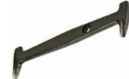
Pour réaliser l'encoche dans le sabot pour loger l'épaisseur du rivet. Modèle réalisé en acier forgé. Double gouge pour utilisation ambidextre. Poids 190 g.
