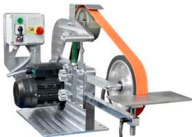
Ponceuse à bande backstand adaptée à la maréchalerie. Moteur à condensateur, monophasé 220 volts, 3000 tr/mn, puissance 1100 Watt. Equipé avec boîtier à bouton marche arrêt, sécurité magnéto thermique + inverseur de sens de rotation pour l'affûtage + arrêt coup de poing. Poulie moteur et clavetage adaptés. Avec roue de contact 250 x 50 mm. (Livré sans table à planer)
