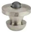
Augmente la résistance à l'usure des fers et chaussons en plastique ou polyuréthane, sur les terrains très abrasifs, ainsi que l'adhérence sur la glace ou l'herbe mouillée. Tête ronde diamètre 10 mm, dépassement 3 mm au-dessus du fer. Percer Ø 4,6 mm x prof. 7 mm minimum et emmancher en force dans le plastique.
