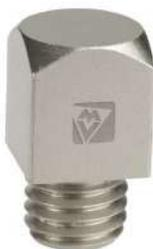
Fers d'épaisseur 8 ou 10 mm. Terrains secs. Tête carrée, clé de 12 mm, dépassement 15 mm au-dessus du fer. Percer Ø 8,5 mm et utiliser un taraud M10x150.
