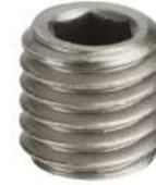
Pour la protection des filetages du fer après démontage des crampons filetage M10. Pas de prééminence au-dessus du fer. Filetage M10x150. S'utilise avec une clé six pans creux, clé de 5 mm. Pour fers d'épaisseur 10 mm.
