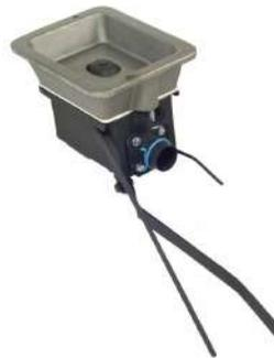
Dimensions intérieures 290x200x65 mm - Poids 22 kg. Âtre en fonte de forte épaisseur équipés d'un système de diffusion/concentration du flux d'air grâce à une soupape centrale commandée par un levier. Un autre levier commande le débit d'air, un 3ème manoeuvre la trappe d'évacuation du mâchefer. Arrivée d'air ø 50 mm.
