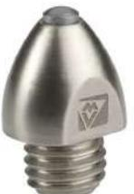
Fers d'épaisseur 8 ou 10 mm. Terrains secs. Tête ovale diamètre 15 mm, clé de 12 mm, dépassement 14,5 mm au-dessus du fer. Percer Ø 8,5 mm et utiliser un taraud M10x150.
