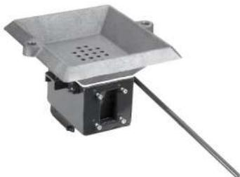
Âtre en fonte de forte épaisseur avec diffusion centrale. Un levier commande le débit d'air, un autre la trappe d'évacuation du mâchefer. Entrée d'air rectangulaire : 35x65 mm.
