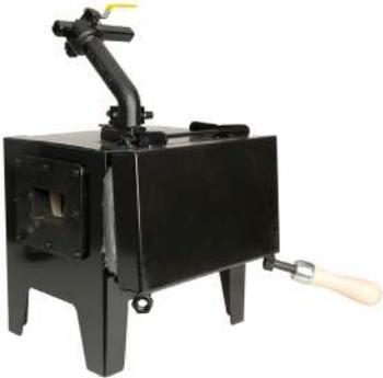
Forge à gaz propane de construction robuste. 1 brûleur, isolation en fibre céramique y compris dans la porte, sole en briques réfractaires dures, allumage piézoélectrique, mano-détendeur et tuyau inclus. Super économique grâce au faible volume du foyer, à sa porte, son isolation et sa faible pression.
