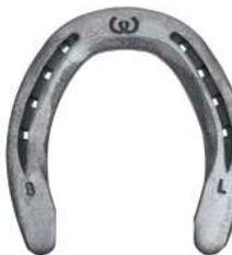
Le Ryder Original est connu pour son modèle de forme facile classique et éprouvée. Le Ryder Original section 22x8 mm présente une rive interne concave qui réduit le poids et minimise le risque du cheval qui forge, tout en offrant plus de traction.
