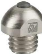
Fers d'épaisseur 8 ou 10 mm. Terrains durs et glace. Tête ovale diamètre 15 mm, clé de 12 mm, dépassement 9,5 mm au-dessus du fer. Percer Ø 8,5 mm et utiliser un taraud M10x150.
