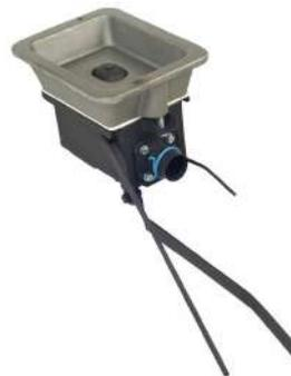
Dimensions intérieures 340x225x77 mm - Poids 25 kg.. Âtre en fonte de forte épaisseur équipés d'un système de diffusion/concentration du flux d'air grâce à une soupape centrale commandée par un levier. Un autre levier commande le débit d'air, un 3ème manoeuvre la trappe d'évacuation du mâchefer. Arrivée d'air ø 50 mm.
