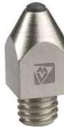
Profil accrocheur ! Fers d'épaisseur 8 ou 10 mm. Terrains gras/sable. Tête carrée, clé de 12 mm. Dépassement 20,5 mm au-dessus du fer. Percer Ø 8,5 mm et utiliser un taraud M10x150.
