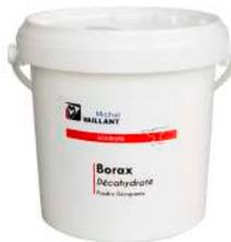
Poudre décapante indispensable pour réaliser les soudures à blanc des aciers dans les fours à gaz ou les forges à charbon. Déposer une fine couche sur les parties à souder pendant la chauffe, juste avant l'opération de soudure au marteau.
