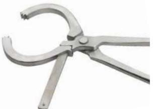
Pince à sonder ajustable pour tester la sensibilité du pied entre la sole et la muraille. Sa flexibilité d'ouverture permet de s'adapter à différentes tailles de sabots. Poids 1,1 kg.
