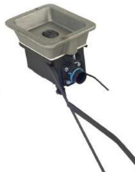
Dimensions intérieures : 470x260x105 mm - Poids 40 kg.. Âtre en fonte de forte épaisseur équipés d'un système de diffusion/concentration du flux d'air grâce à une soupape centrale commandée par un levier. Un autre levier commande le débit d'air, un 3ème manoeuvre la trappe d'évacuation du mâchefer. Arrivée d'air ø 50 mm.
