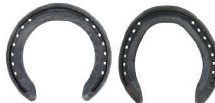
Couverture spécifique Xtra : la section plus large permet un soutien supplémentaire et limite l'usure. Eponges plus couvertes pour plus de soutien en talon. Traction grâce à la section concave et aux rives externes du fer. Des étampes supplémentaires ont été ajoutées pour plus d'options lors du brochage et pour permettre la pose des fer à l'envers. Clous conseillés : FJ - HammerHead.
