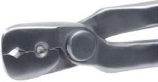
Permet un travail en finesse pour déferrer un cheval aux parois fragiles ou pour retirer quelques clous seulement. Après avoir coupé le rivet à l'aide du dérivoir, saisir la tête du clou noyé dans la rainure avec la partie la plus effilée de la pince. Avec un mouvement de levier, tirer le clou une
