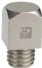
Fers d'épaisseur 8 ou 10 mm. Terrains secs. Tête carrée, clé de 10 mm, dépassement 12 mm au-dessus du fer. Percer Ø 8,5 mm et utiliser un taraud M10x150.
