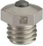
Le crampon d'été par excellence, pour randonnée et goudron. Terrains durs/impénétrables. Fers d'épaisseur 8 ou 10 mm. Tête hexagonale, clé de 12 mm, dépassement 6 mm au-dessus du fer. Percer Ø 8,5 mm et utiliser un taraud M10x150.
