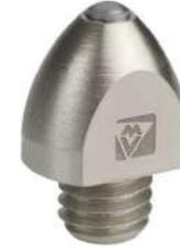
Fers d'épaisseur 8 ou 10 mm. Terrain gras/sable. Tête ovale diamètre 17 mm, clé de 12 mm, dépassement 17,5 mm au-dessus du fer. Percer Ø 8,5 mm et utiliser un taraud M10x150.
