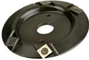
Outil rotatif se montant sur une meuleuse d'angle, pour le parage des bovins ou des chevaux maintenus en cage de contention. Fraise à parer avec 4 plaquettes de carbure de tungstène réversibles et interchangeables. Excellente coupe progressive, sans vibration. Diamètre 115 mm, alésage intérieur diamètre 22,5 mm. Vis et plaquettes carbure vendues séparément.
