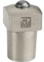
Conçu pour terrains durs, pour les randonnées et sur la neige. Fers d'épaisseur 10mm. Tête carrée, clé de 10 mm, dépassement 7,5 mm. Queue conique, percer Ø 8,5 mm et utiliser la bouterolle conique réf. BOUT1.
