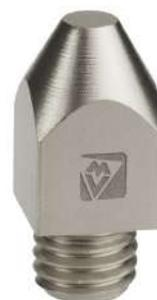
Profil accrocheur ! Fers d'épaisseur 8 ou 10 mm. Terrains gras/sable. Tête carrée, clé de 12 mm, dépassement 19 mm au-dessus du fer. Percer Ø 8,5 mm et utiliser un taraud M10x150.
