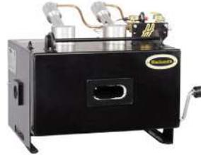
Forge à gaz portable à 2 brûleurs. Modèle robuste avec 2 ouvertures latérales prévues pour permettre le passage de barres. Il suffit de découper la fibre isolante pour les ouvrir. Dimensions du foyer : Longueur 310 mm x Profondeur 235 mm x hauteur 100 mm.
