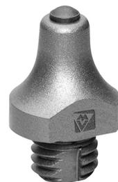
Taraut intégré au crampon : vous n'avez plus besoin de refaire les mortaises avant de cramponner ! Vissez directement vos crampons, le filetage se répare en même temps. Design hard ground - sol dur. Dépassement 20 mm. Filetage self-cleaning. Crampons durcis avec tungstène pour plus de résistance.
