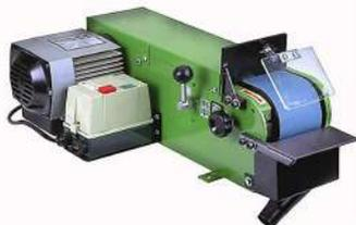
Puissante ponceuse à bande d'établi pour atelier ou véhicule, idéale pour réaliser les fils d'argent et pour biseauter les éponges. Roue large. Moteur 220 volts monophasé 1000 watts. Bande 100 x 1220 mm. Poids 28 kg.
