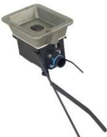
Dimensions intérieures 250x175x53 mm. Poids 19 kg. Âtre en fonte de forte épaisseur équipés d'un système de diffusion/concentration du flux d'air grâce à une soupape centrale commandée par un levier. Un autre levier commande le débit d'air, un 3ème manoeuvre la trappe d'évacuation du mâchefer. Arrivée d'air ø 50 mm.
