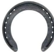
Couverture spécifique Xtra : la section plus large permet un soutien supplémentaire et limite l'usure. Éponges plus couvertes pour plus de soutien en talon. Traction grâce à la section concave et aux rives externes du fer. Des étampes supplémentaires ont été ajoutées pour plus d'options lors du brochage et pour permettre la pose des fer à l'envers. Clous conseillés : FJ - HammerHead.
