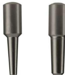
Pour poser correctement les crampons coniques, il est indispensable que la queue conique et le trou dans lequel on doit les assembler aient la même géométrie. Le trou cylindrique percé au préalable est transformé en trou conique par étampage, à l'aide de la bouterolle.
