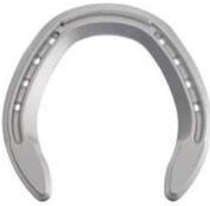
Fers antérieurs à 2 pinçons. Disponibles également en tournure postérieure. Dimensions identiques aux fers «Eventer» acier et «Future». Grappe en acier pour éviter une trop forte usure. Petites déformations à froid possible. Forge à chaud T° maxi = 420°C avec risque de perte de dureté. Etampures américaines. Clous conseillés : ASM 4,5.
