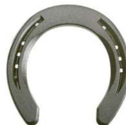
Fer en acier développé par Mustad. Pince biseautée pour faciliter la bascule du pied en fin d'appui. Couverture en pince plus importante que la couverture en éponges.
