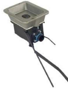
Dimensions intérieures 270x205x57 mm. Poids 20 kg. Âtre en fonte de forte épaisseur équipés d'un système de diffusion/concentration du flux d'air grâce à une soupape centrale commandée par un levier. Un autre levier commande le débit d'air, un 3ème manoeuvre la trappe d'évacuation du mâchefer. Arrivée d'air ø 50 mm.
