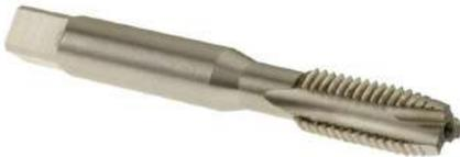
Taraud machine avec affûtage spécial pour trou débouchant, repoussant le copeau vers l'avant. Entrée progressive sur 4 filets. Acier rapide supérieur de première qualité.
