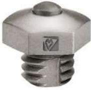
Taraut intégré au crampon : vous n'avez plus besoin de refaire les mortaises avant de cramponner ! Vissez directement vos crampons, le filetage se répare en même temps. Design hard ground - sol dur. Dépassement 6 mm. Filetage self-cleaning. Crampons durcis avec tungstène pour plus de résistance.
