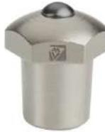
Le crampon d'été par excellence, pour randonnée et goudron. Fers d'épaisseur 10 mm. Tête hexagonale, clé de 12 mm, dépassement 6 mm au-dessus du fer. Queue conique, percer Ø 8,5 mm et utiliser la bouterolle conique réf. BOUT1.
