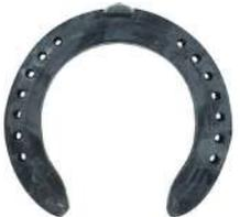
La présence d'une couche supplémentaire en polyuréthane vise à procurer du soulagement aux soles sensibles et à offrir des bénéfices anti-chocs. Assure légèreté et flexibilité. Confortable et amortissant, il limite l'usure du fer. Antérieur 1 pinçon. Section 21x12 mm. Tailles 5 : 118g Taille 6 : 125 g Taille 7 : 143g Taille 8 : 158g
