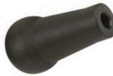
Forme ergonomique : facilite le travail grâce à l'excellente prise en main. Plastique très résistant. Emmanchement conique sur la soie de la râpe : rapide, sûr, efficace et démontable facilement. Poids 150 g.
