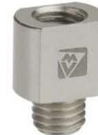
Pour terrain très gras. Réhausse le cramponnage de plus de 15 mm. Fers d'épaisseur 8 ou 10 mm. Tête ovale diamètre 17 mm, clé de 12 mm, pouvant recevoir tous les crampons filetage M10x150. Percer Ø 8,5 mm et utiliser un taraud M10x150.
