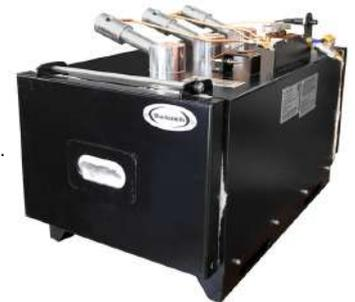
Modèle similaire au G avec un foyer de plus grande taille. Forge à gaz propane à 3 brûleurs d'un excellent rapport qualité / prix. Foyer de type tunnel, fermant à chaque extrémité avec 2 portes isolées.
