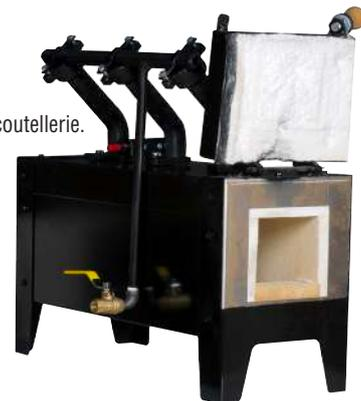
Profondeur 530 mm - Foyer traversant - Spécial lames longues. Montée en température rapide grâce aux 3 Brûleurs et un foyer de faible section. Consommation raisonnable de propane grâce à une isolation renforcée.
