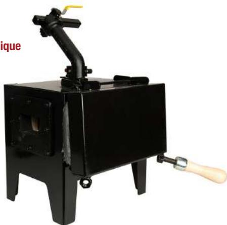
Forge à gaz propane (ou butane) de construction robuste. 1 brûleur, isolation en fibre céramique y compris dans la porte, sole en briques réfractaires dures, allumage piézoélectrique, mano-détendeur et tuyau inclus. Super économique grâce au faible volume du foyer, à sa porte, son isolation et sa faible pression.
