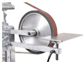
Roues de contact avec revêtement périphérique en caoutchouc vulcanisé, dureté 70 Shore D. Sur demande, il est possible de livrer avec ce revêtement cranté. Montée sur roulements de précision à haute vitesse. Directement ajustée sur son bras qui s'installe en lieu et place de la table à planer.
