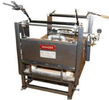
Forge à gaz propane d'atelier 4 brûleurs et un foyer long. Fermeture à chaque extrémité avec 2 portes guillottes isolées, réglables en hauteur. 2 supports de barre extérieurs à rouleaux permettant un accès et un maintien plus facile de la pièce. Allumage piezo-électrique, mano-détendeur et tuyau inclus. Construction robuste. Isolation en fibre céramique. Sole et côtés protégés de l'abrasion par des briques réfractaires interchangeables.
