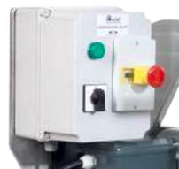
Modèle Sans Vario : Boîtier à sécurité magnéto thermique + arrêt coup de poing + inverseur du sens de rotation
