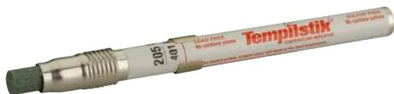
C'est un moyen simple et efficace pour contrôler la température directement sur la pièce chauffée. Le dépôt solide laissé par cette craie grasse sur la pièce mise au four se liquéfie à la température indiquée. Idéal pour vérifier les températures en soudure, traitements thermiques ou fonderie.
