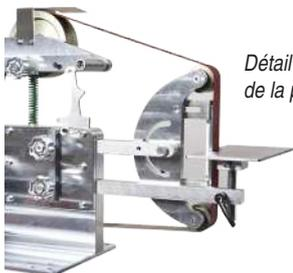
Détail du système de réglage de la plaque d'appui
