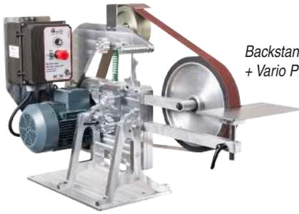
Backstand avec moteur 2200 Watt + Vario Pro + roue de 300mm
