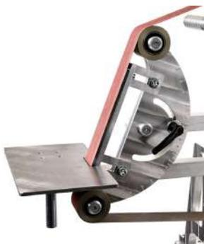
Les plaques d'appui repose-mains, montées sur des bras indépendants, offrent une flexibilité essentielle pour les couteliers. Elles permettent de régler la proximité de la bande en fonction de la tâche à accomplir, quel que soit l'objectif du travail. Backstand livré avec une plaque standard d'une largeur 280 mm. Peut fonctionner avec les roues de contact de tous diamètres.
