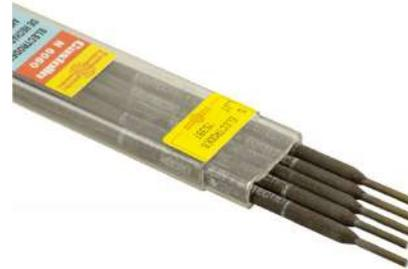
Electrodes enrobées destinées à la réalisation de couches anti-usure sur les fers. Alliage à teneur élevée en chrome et contenant une forte densité de constituants durs et très fins. Boîte de 5 électrodes diamètre 3,2 mm.
