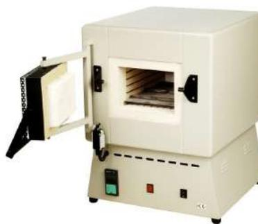
Four de trempe spécialement étudié pour le traitement thermique des aciers. Structure en tôle d'acier et partie frontale en acier moulé de 8 mm d'épaisseur pour une grande résistance. Profondeur de 320 mm permettant de tremper une grande plage de longueurs de lames... Réglage digital de la température et affichage numérique pour plus de précision. Isolation thermique en fibre céramique et foyer fabriqué
