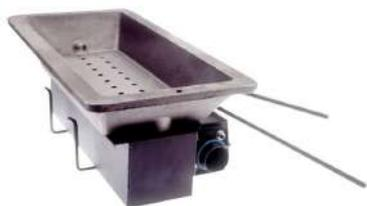
Âtre en fonte de forte épaisseur et de grande longueur. Répartition de la ventilation sur toute la longueur ou possibilité de séparer en 2 zones pour réduire le feu à la moitié de sa longueur. Un levier commande le débit d'air, un autre la séparation en 2 zones et un 3ème manoeuvre la trappe d'évacuation du mâchefer.
