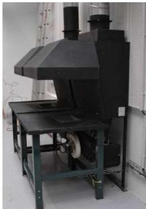
Hotte qui aspire, filtre et sépare la suie et la poussière par un effet cyclone. Se monte directement sur la forge (entre la forge et le mur).
