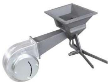
Kit composé d'un foyer en fonte avec un ventilateur PO. Foyer en fonte équipé d'un système de régulation du flux d'air grâce à une soupape centrale commandée par un levier. Un deuxième levier commande une trappe d'évacuation du mâchefer.
