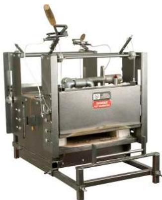
Forge à gaz propane à 3 brûleurs spécialement étudiée pour la ferronnerie. Foyer spacieux fermant à chaque extrémité avec 2 portes guillottes isolées, réglables en hauteur. 2 supports de barre extérieurs à rouleaux permettant un accès et un maintien plus facile de la pièce. Allumage piezo-électrique, mano-détendeur et tuyau inclus. Construction robuste. Isolation en fibre céramique. Sole et côtés protégés de l'abrasion par des briques réfractaires interchangeables.
