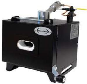
Forge P/E, très populaire en Europe, compacte et performante. Brûleur adapté aux besoins quotidiens. Bloc réfractaire OPR pour une meilleure gestion de la chaleur. Structure solide, plus durable et facile à remplacer. Isolation de 40 mm d'épaisseur. Température maximale de 1600°C. Consommation de propane : 0,62 kg/h à 0,5 bar, 1,24 kg/h à 1 bar.
