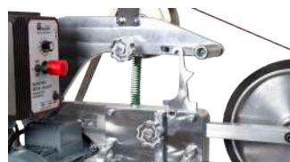
Système de blocage du levier de tension pour faciliter le changement de la bande en mode «mains-libres»
