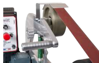
Détail poulie de tension avec bouton de réglage d'alignement de la bande
