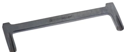
Pour réaliser l'encoche dans le sabot pour loger l'épaisseur du rivet.
