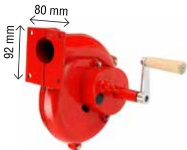
Ventilateur de forge à manivelle et engrenage.
