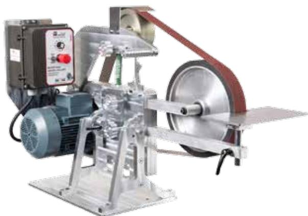
*Backstand avec moteur 2200 Watt + Vario Pro
