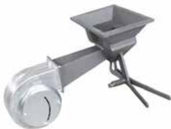
Kit composé d'un foyer en fonte avec un ventilateur P0. Foyer en fonte équipé d'un système de régulation du flux d'air grâce à une soupape centrale commandée par un levier. Un deuxième levier commande une trappe d'évacuation du mâchefer.
