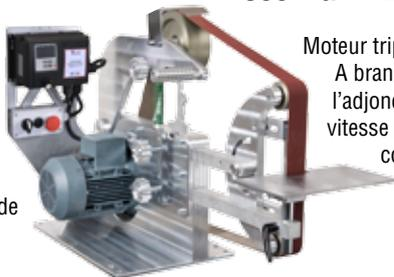
Moteur triphasé 220 volts, 3000 tr/mn, puissance 1500 Watt. A brancher sur une prise en 220 volts monophasé grâce à l'adjonction d'un variateur type Economique - Variation de vitesse par variation de fréquence de 20 à 50 Hertz (50Hz correspondant à la vitesse nominale du moteur), inversion de sens, sécurité arrêt coup de poing. Poulie moteur et clavetage adaptés.
