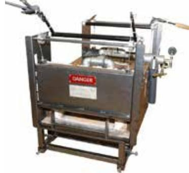
Forge à gaz propane d'atelier 4 brûleurs et un foyer long. Fermeture à chaque extrémité avec 2 portes guillotines isolées, réglables en hauteur. 2 supports de barre extérieurs à rouleaux permettant un accès et un maintien plus facile de la pièce. Allumage piezo-électrique, mano-détendeur et tuyau inclus. Construction robuste. Isolation en fibre céramique. Sole et côtés protégés de l'abrasion par des briques réfractaires interchangeables.
