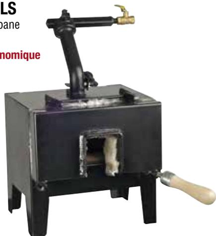
Forge à gaz propane (ou butane) de construction robuste. 1 brûleur, isolation en fibre céramique y compris dans la porte, sole en briques réfractaires dures, allumage piézoélectrique, mano-détendeur et tuyau inclus. Super économique grâce au faible volume du foyer, à sa porte, son isolation et sa faible pression.
