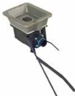
Âtre en fonte de forte épaisseur équipés d'un système de diffusion/concentration du flux d'air grâce à une soupape centrale commandée par un levier. Un autre levier commande le débit d'air, un 3ème manoeuvre la trappe d'évacuation du mâchefer.
