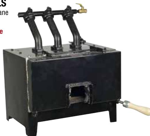
Forge à gaz propane (ou butane) à 3 brûleurs avec un foyer haut et spacieux. Ouverture arrière pour passer des barres. Allumage piezo-électrique, mano-détendeur et tuyau inclus. Construction robuste. Isolation en fibre céramique et sole en brique réfractaire dure.
