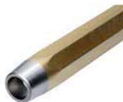
Le chasse-rivet permet de serrer l'assemblage sur le rivet avant de riveter à l'aide de la bouterolle. Après avoir percé les pièces, on les assemble sur le rivet. On place ensuite la tête du rivet contre l'enclume par exemple puis on positionne le chasse-rivet sur la tige du rivet avant de frapper pour serrer l'assemblage.
