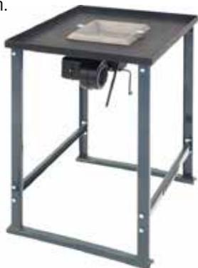
Forge à charbon économique avec foyer en fonte EE1 dimension intérieure 215x195 mm. Réglage d'air précis par un clapet à levier et 2ème clapet pour le mâchefer.
