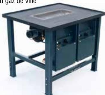
Forge à gaz propane (ou gaz de ville en option) fonctionnant avec des chips en céramique. Grâce aux brûleurs gaz, les chips céramique deviennent incandescentes, formant ainsi un foyer de braises similaire à celui d'une forge à charbon. Identique au modèle G800 mais avec un bâti plus grand et un foyer plus long.
