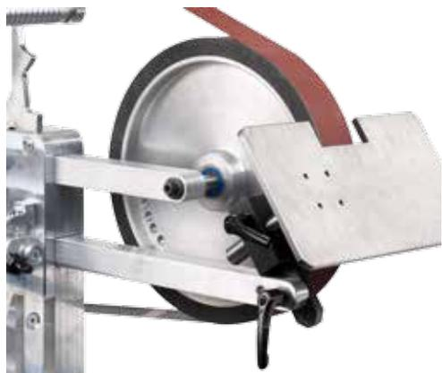
*Plaque d'appui orientable en position inclinée*
