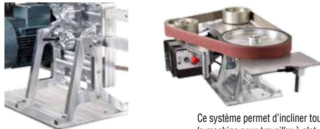
Ce système permet d'incliner toute la machine pour travailler à plat (table repose-main à l'horizontal). Le système complet se monte en lieu et place de 4 vis de fixation préexistantes. Le backstand ainsi monté peut basculer de 90° par le simple déblocage d'une poignée à vis. Le pré-positionnement en position verticale ou horizontale
