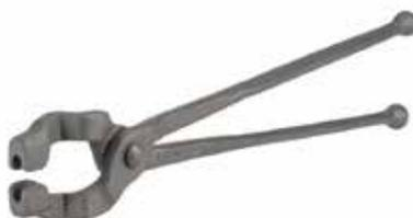
Pincettes de forge en U décalé permettant de serrer la matière par le côté (permet de laisser dépasser la matière le long de la tenaille). Pour serrer des fers plats sur le chant section 10x6, 25x6, 38x6 ou 50x6 mm. Idéale pour la coutellerie et notamment la forge des soies.
