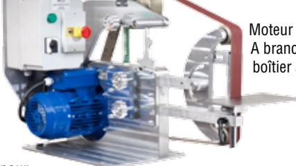
Moteur triphasé 400 volts, 3000 tr/mn, puissance 2200 Watt. A brancher sur une prise en 400 volts triphasé. Equipé avec boîtier à bouton marche arrêt, sécurité magnéto thermique + inversion de sens de rotation + arrêt coup de poing. Poulie moteur et clavetage adaptés.
