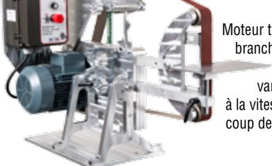
Moteur triphasé 400 volts, 3000 tr/mn, puissance 2200 Watt. A brancher sur une prise en 400 volts triphasé. Equipé avec un variateur type Professionnel 400 - Variation de vitesse par variation de fréquence de 20 à 60 Hertz (50Hz correspondant à la vitesse nominale du moteur), inversion de sens, sécurité arrêt coup de poing. Poulie moteur et clavetage adaptés.
