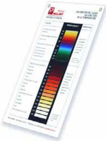
Tableau indicateur nécessaire à l'interprétation de la température en fonction de la couleur de l'acier chauffé :
