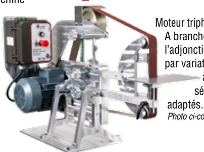
Moteur triphasé 220 volts, 3000 tr/mn, puissance 2200 Watt. A brancher sur une prise en 220 volts monophasé grâce à l'adjonction d'un variateur type Professionnel - Variation de vitesse par variation de fréquence de 20 à 60 Hertz (50Hz correspondant à la vitesse nominale du moteur), inversion de sens, sécurité arrêt coup de poing. Poulie moteur et clavetage adaptés.
