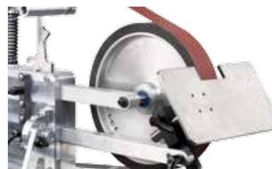
Système à 3 biellettes pour orientation de la plaque d'appui multipositions. Blocage super énergétique par système à tampon tangent. Peut être utilisé comme guide d'usinage angulaire et guide pour l'émouturage. Livrée avec son bras.
